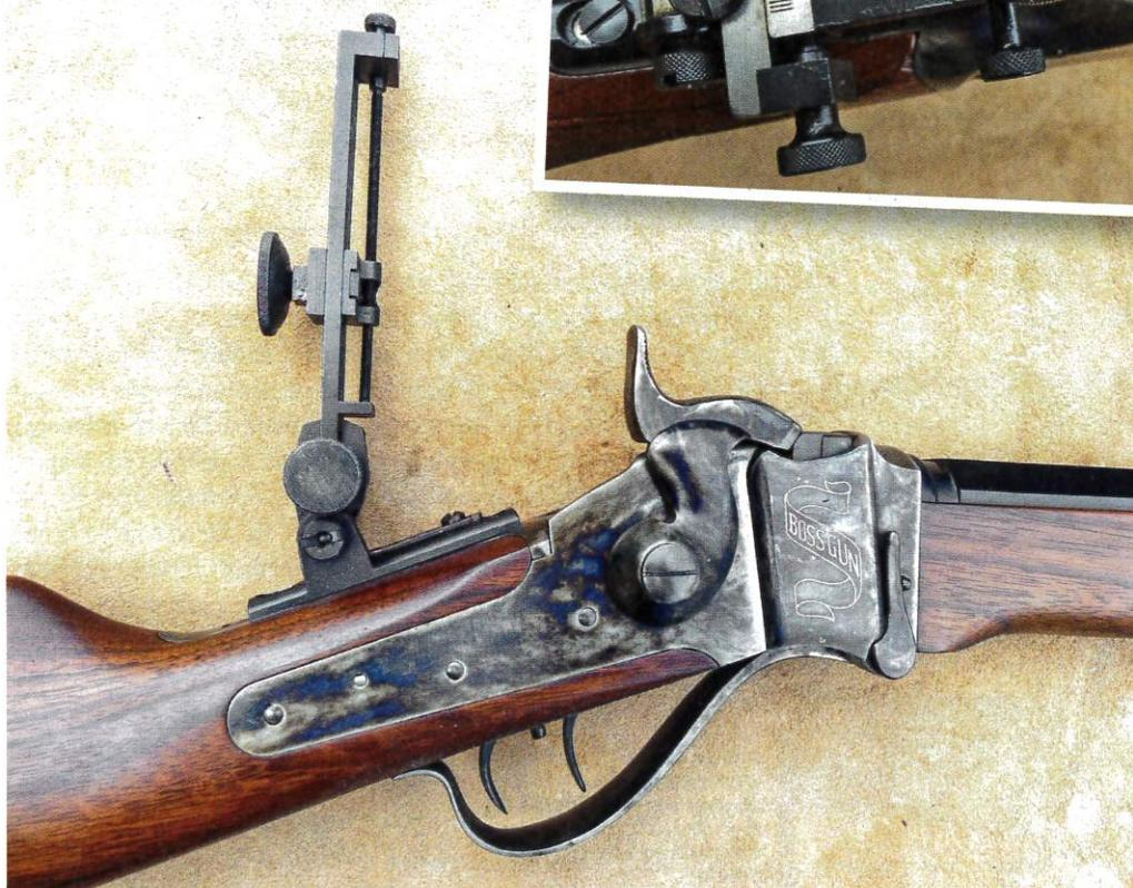
**1, 2 & 3** - Le dioptre Goodwin Long Range Silhouette USA 407 comporte un cadre déporté latéralement. L'amplitude du réglage en dérive atteint 1/2" de part et d'autre du repère neutre. Son embase dispose d'une vis pour régler l'équerrage par rapport à l'axe du canon.
